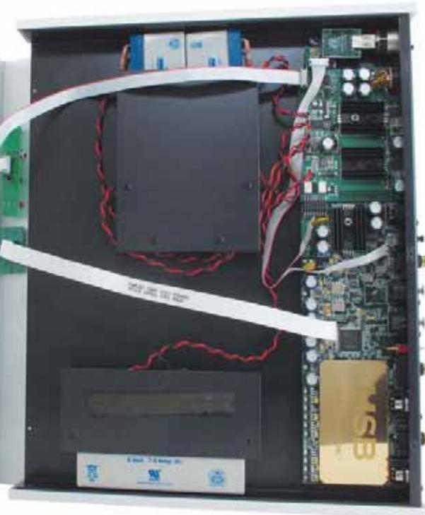
La lunga piastra posta a ridosso della parte posteriore ospita, in posizione mediana e laterale, il filtro digitale e l'apparato di conversione blindato. Sul lato opposto sono ospitati, oltre all'ingresso USB, i dispositivi regolatori dell'alimentazione.
