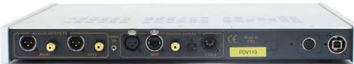
Posteriormente si osservano, da sinistra verso destra, le uscite analogiche RCA e Cannon. Di seguito, un interruttore che abilita l'acquisizione di nuovi parametri di settaggio del filtro digitale da compact-disc e, a seguire, la nutrita serie dei connettori di ingresso XLR, RCA s/pdf, RJ45 e Toslink. Sulla destra il connettore DIN per l'alimentatore esterno e l'ingresso per una connessione USB "B". Come si può osservare, l'apparecchio in prova aveva la segnatura matricolare PDV119.
