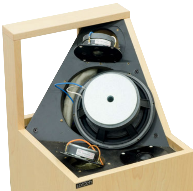
Ecco come si presenta la zona verticale accanto al tweeter senza il pannellino in materiale fonoassorbente. I due tweeter secondari, connessi in serie, sono anch'essi di produzione Scan-Speak.
