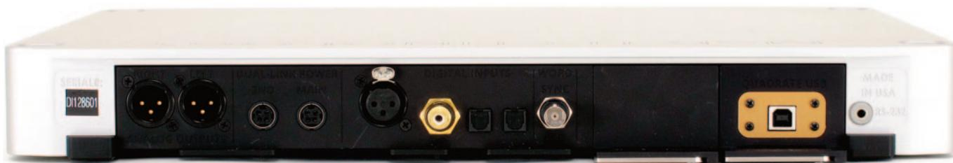
I collegamenti posteriori sono da sinistra verso destra rispettivamente: la coppia di connettori bilanciati analogici XLR, la coppia di connettori di alimentazione a 4 pin per l'alimentatore esterno (da utilizzare con adattatore), l'ingresso AES/EBU Xlr, l'ingresso digitale BNC, il doppio connettore ottico, quello classico e quello proprietario, l'ingresso word sync e infine l'ingresso USB.
