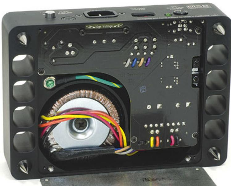
L'interno dell'unità di alimentazione, il cui chassis è pure fresato dal pieno come l'unità principale.
