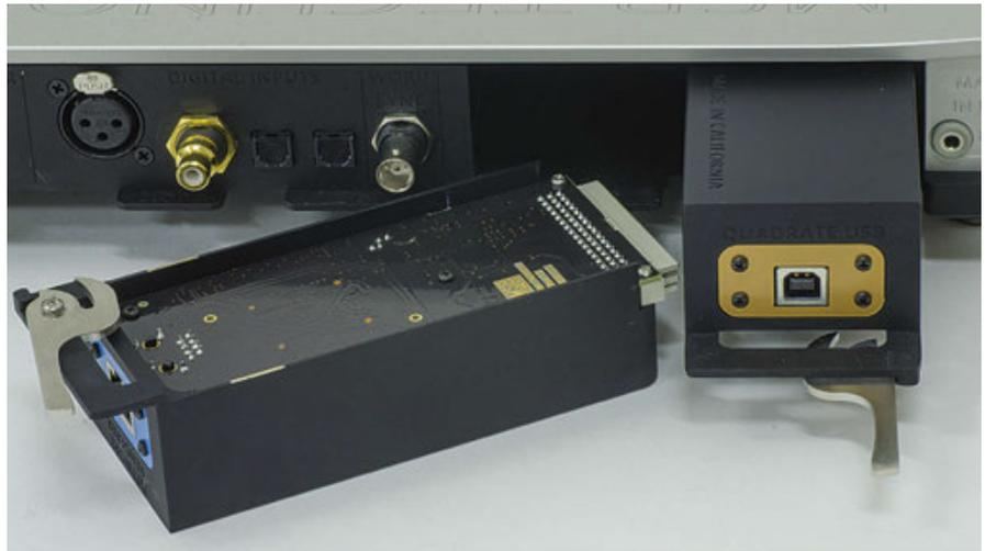
*Per montare e smontare gli ingressi opzionali non occorre rivolgersi ad un tecnico qualificato, basta gestire l'apposita levetta nel semplice modo descritto nel manuale.*
