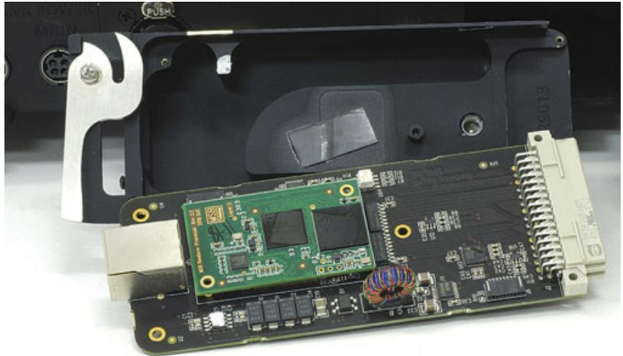
*Nel nostro caso erano montati il modulo USB (“Quad Rate DSD MQA”) e quello per operare da renderer in una rete ethernet (“Renderer II ethernet”, DLNA e RAAT) di cui vediamo l'interno.*
