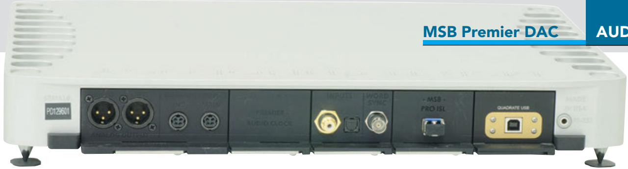
I moduli sono facilmente estraibili agendo sulle rispettive leve/maniglie poste in basso.
