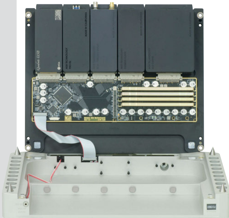
Il telaio è un pezzo unico, fresato dal pieno.
