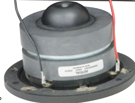
Il tweeter, credo di provenienza Scan Speak appare pesantemente modificato dai tecnici Aerial, con una flangia appena differente ed un rifasatore centrale diverso dall'originale. Notate anche in questo caso il secondo anello di ferrite.
