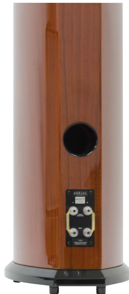
Il condotto di accordo è sistemato sulla stretta parete posteriore. Circa 67 millimetri di diametro scongiurano l'insorgere di turbolenze.
