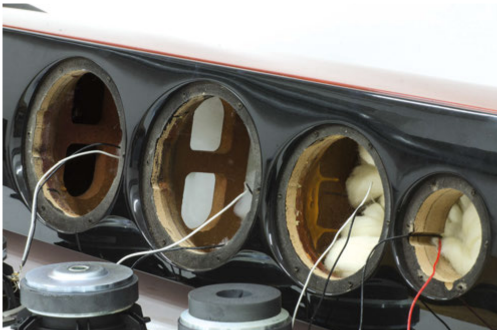
Il diffusore smontato. Notiamo i notevoli rinforzi interni e due diversi tipi di assorbente acustico, più morbido per il volume del midwoofer e a pannelli per i woofer sottostanti.
