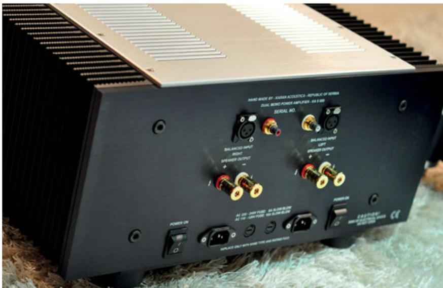
Notare sul retro le connessioni IEC per due cavi di alimentazione.
