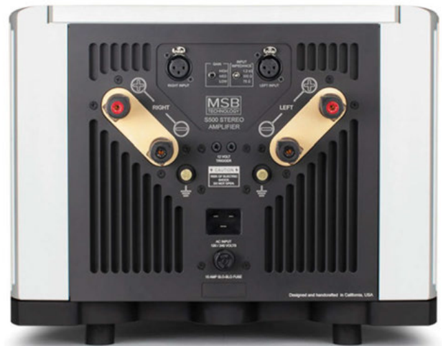
Il pannello posteriore dell'S500. Si notino al centro in alto gli interruttori per il guadagno e l'impedenza di ingresso.
