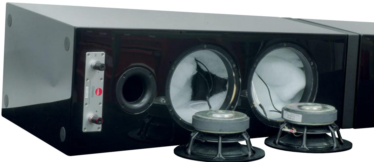
*I woofer sono posizionati posteriormente. Notare la bombatura sul fondello del complesso magnetico ed il condotto ben avvitato al mobile. A sinistra vediamo i due soli connettori previsti dal costruttore.*
