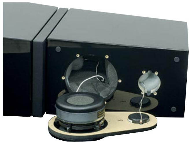
Rimossi i due altoparlanti notiamo il piccolo volume a disposizione del midrange e l'assorbente alle spalle del tweeter.
